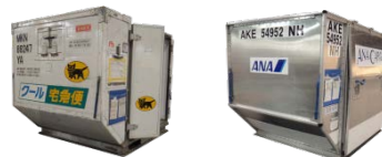
【航空保冷コンテナ】 冷蔵(10℃以下)、冷凍(-15℃以下)
