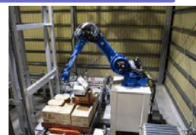
ピッキングロボット
